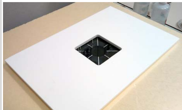
De witte streepjes in het zwarte vlak zijn de elektroden waarlangs het voedsel 'verplaatst' wordt.
